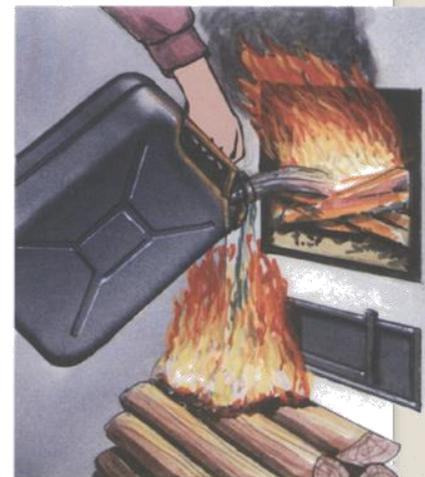
Применение для розжига печей бензина и керосина, выпадение углей, перекалка, трещины в кладке, возгорание сажи в дымоходах
